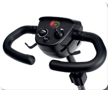
Przyjazny dla użytkownika kontroler ze wskaźnikiem LED stanu baterii
